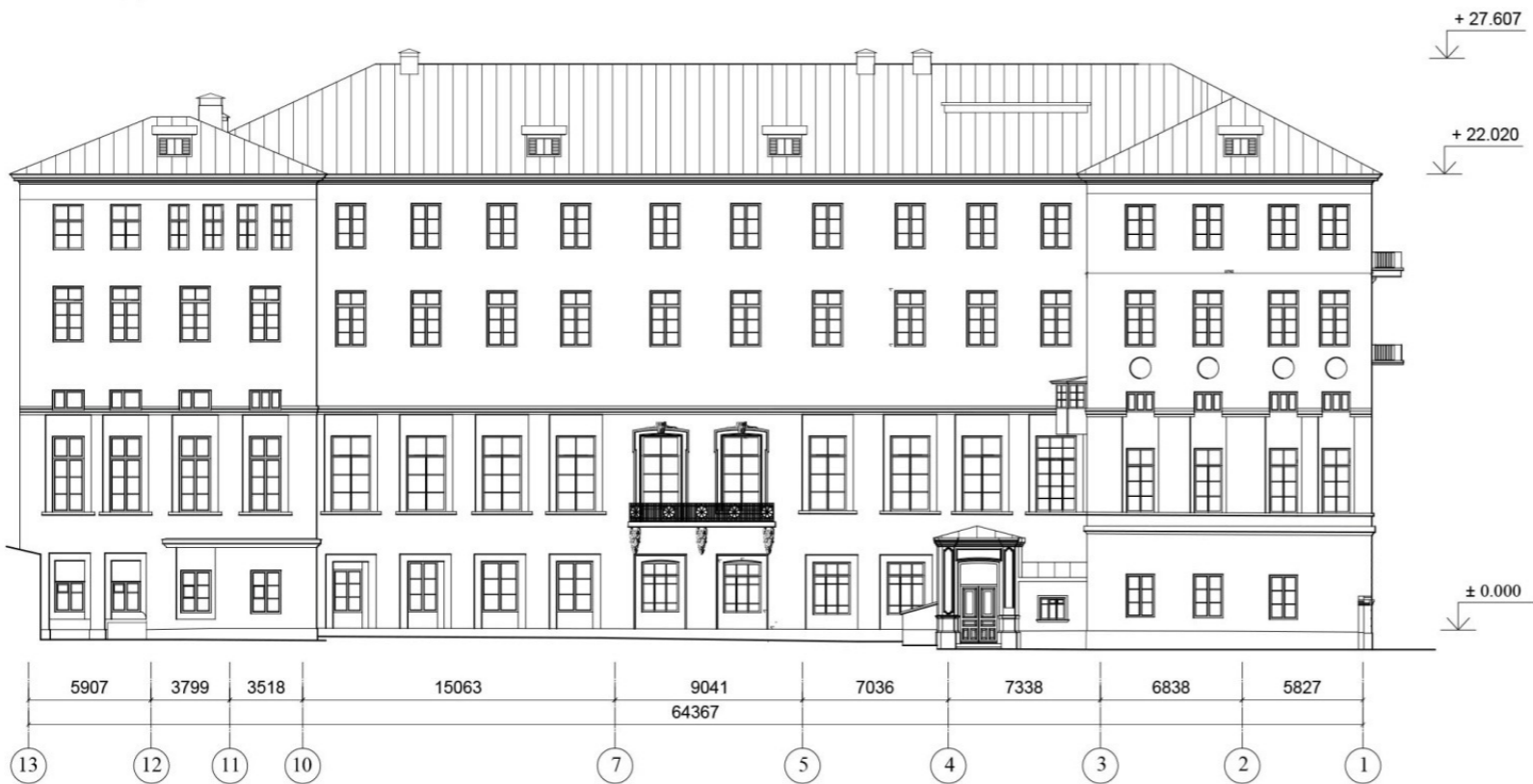
ФАСАД В ОСЯХ 13-1
